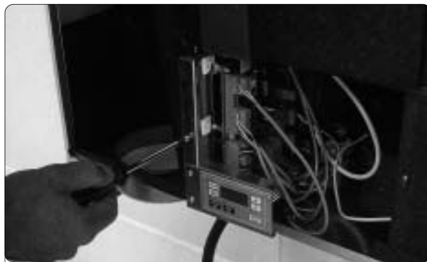
Figuur 15-8. Borging van de electronicslede.
