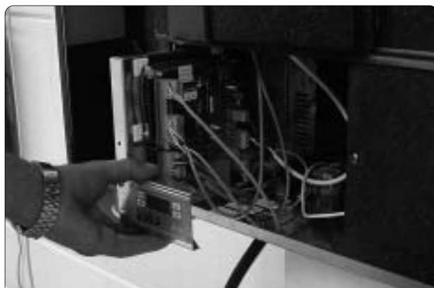
Figuur 15-9. Eruittrekken van de electronicslede.
